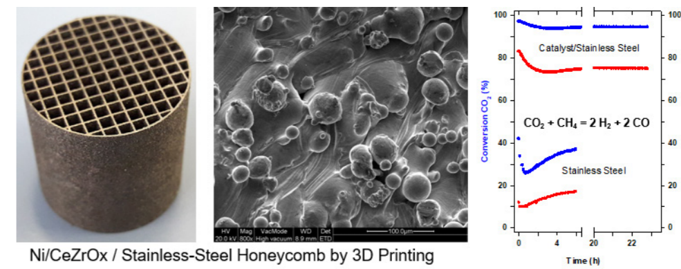
Figura 2. Resultados catalíticos para el reformado seco de metano de catalizadores de níquel soportado sobre monolitos honeycomb de acero obtenidos mediante impresión aditiva 3D, con detalle de su caracterización textural.
