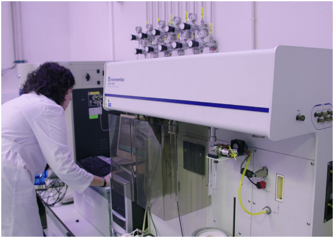
Figura 1. Micromeritis. Medida de dispersión de los catalizadores.
