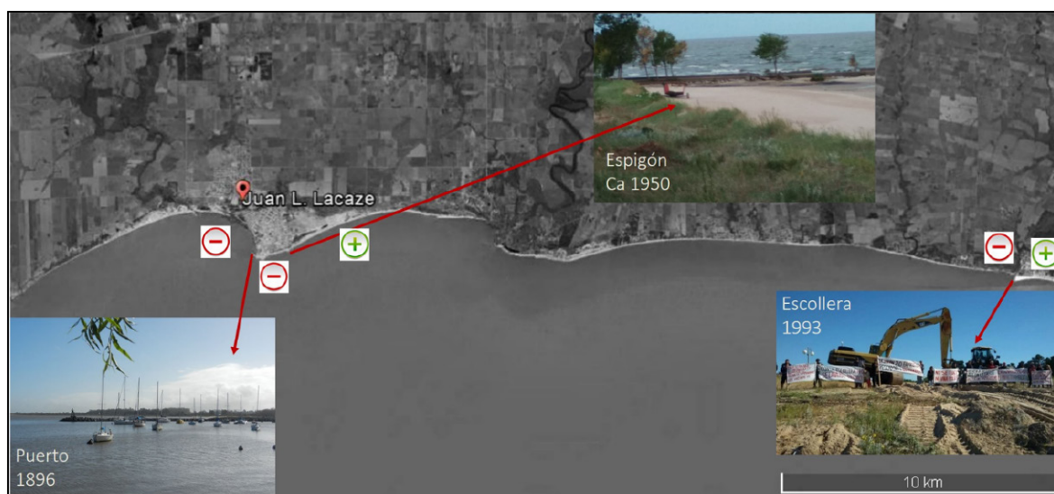
Figura 4. Obras de ingeniería que afectan la dinámica costera, provocando acreción (+) y erosión (-) de arena. En base a Googleearth; Teixeira et al. 2014 y Gutiérrez y Panario 2019.
