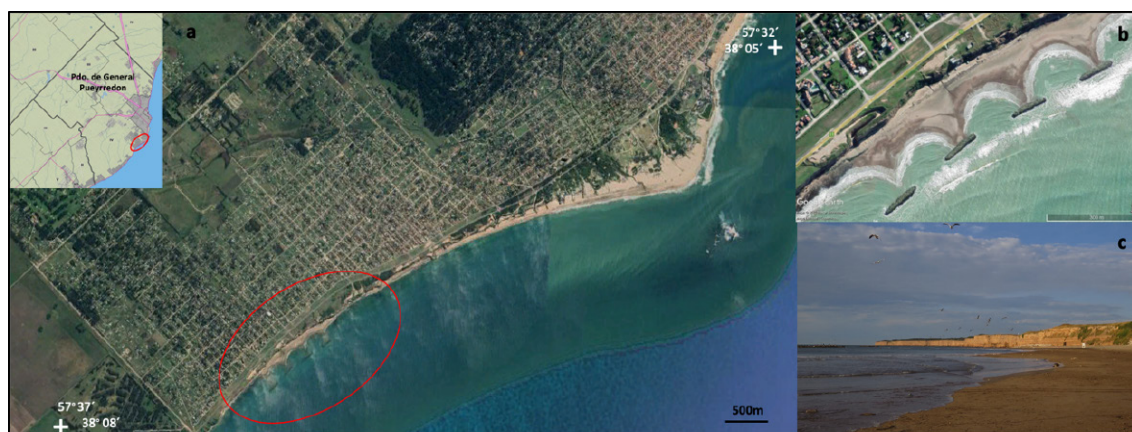
Figura 4. Obra de defensa costera y generación de playas. A) Ubicación. B) Vista de espigones en 2020. C) Playa recuperada.
