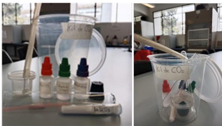
Figura 1. Kit experimental para la obtención y captura de CO<sub>2</sub>.
