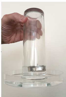
Figura 3. Debido a que la presión en el interior del vaso es inferior a la presión atmosférica, al levantar el vaso, asciende también el plato con la vela y el agua. En esta ocasión se ha empleado una placa Petri como plato, pues su poca masa permite que se pueda levantar con más facilidad.
