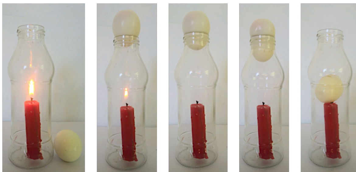
Figura 1. Secuencia de imágenes que corresponden a la succión de un huevo cocido en el interior de un recipiente cuando al taponarlo se apaga una vela encendida en su interior.
