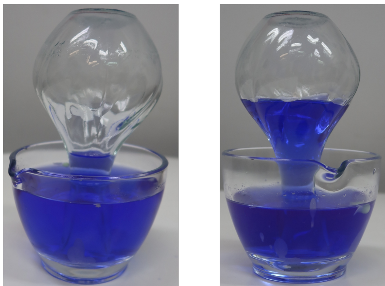
Figura 2. Diferente ascenso del agua en dos recipientes idénticos en los que el aire del interior ha sido calentado a diferentes temperaturas: T = 45\text{ }^{\circ}\text{C} (izquierda); T = 90\text{ }^{\circ}\text{C} (derecha).
