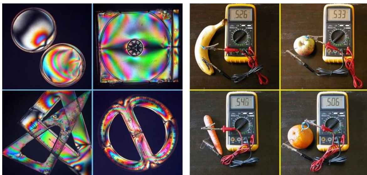
Figura 1.- Ejemplos de actividades manipulativas: birrefringencia y polarización (izquierda); batería electroquímica (derecha).
