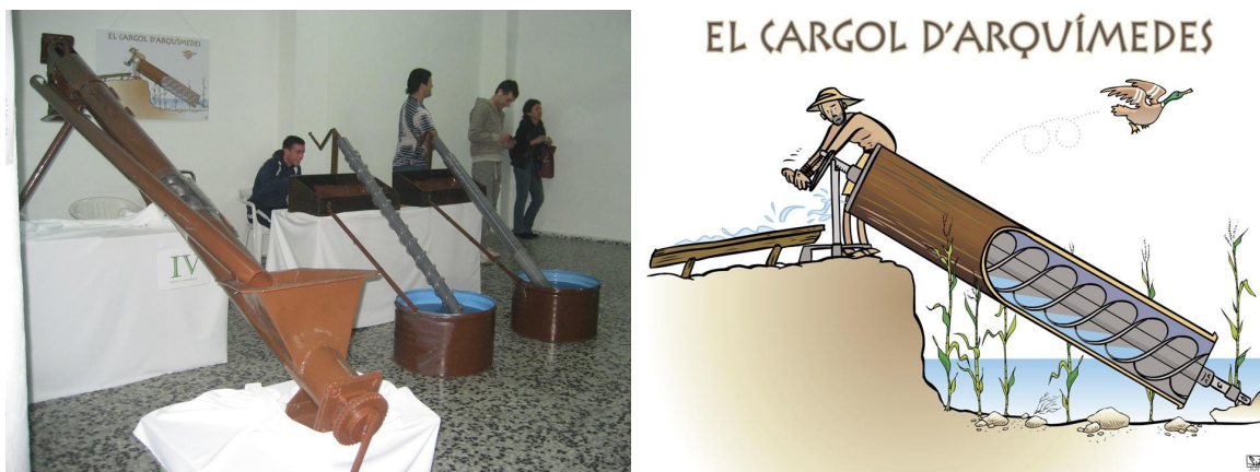
Figura 2.- Tres modelos diferentes de tornillo de Arquímedes que se ofrecen en el taller y dibujo que ofrece un detalle del mismo.
