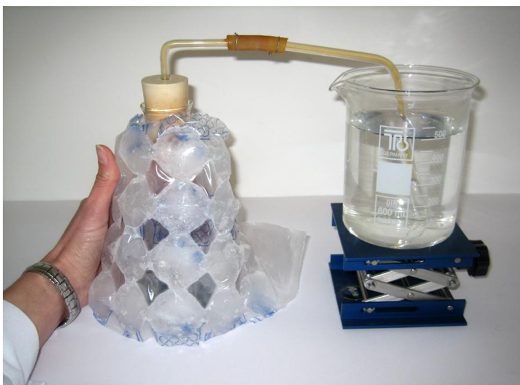
Figura 3.- Al enfriar el matraz con los cubitos de hielo disminuimos la presión en su interior, provocando la subida del agua por el tubo impulsada por la presión atmosférica. El agua sube despacio al principio, pero al llenar el tubo se introduce con fuerza en el matraz.
