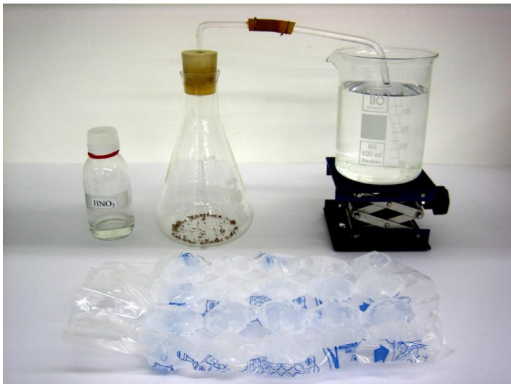
Figura 1.- Montaje de la experiencia. Observamos el erlenmeyer con las virutas de cobre, el vaso de precipitados con agua sobre el elevador y los dos tubos de vidrio unidos por el tubo de goma. El ácido nítrico ( \text{HNO}_3 ) lo llevaremos a la demostración previamente medido. Las bolsas de cubitos de hielo resultan muy prácticas para esta experiencia.
