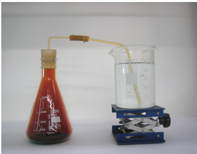
Figura 2.- La reacción entre el cobre y el ácido nítrico ( \text{HNO}_3 ) produce un gas pardo-rojizo, el dióxido de nitrógeno ( \text{NO}_2 ), al tiempo que se desprende gran cantidad de calor. El aumento de temperatura aumenta la presión en el interior del erlenmeyer, provocando la salida con fuerza del gas por el tubo y el burbujeo en el agua.
