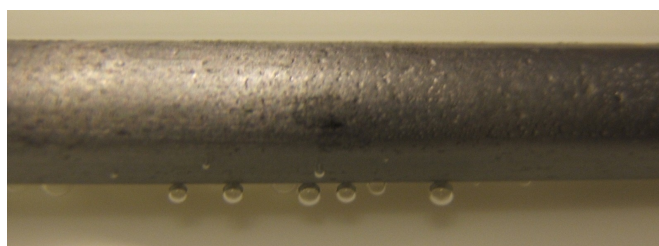
Figura 4. Burbujas de hidrógeno en la superficie del clavo de hierro sumergido en ácido clorhídrico (plato 3).
