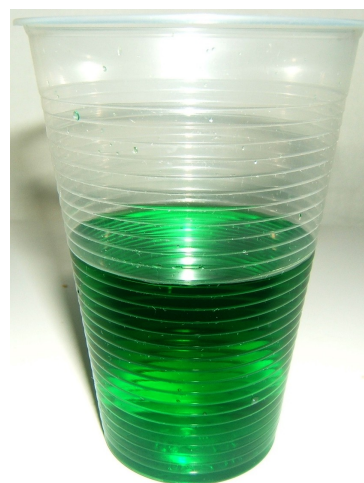
Figura 9. Disolución obtenida cuando se sumerge un trozo de cobre en ácido clorhídrico y agua oxigenada (plato 4).
