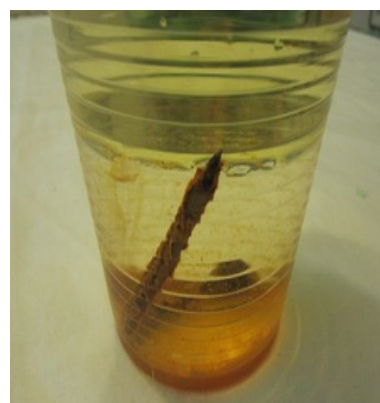
Figura 7. Aspecto del clavo sumergido en el vaso con agua hervida y aceite al cabo de cuatro días.
