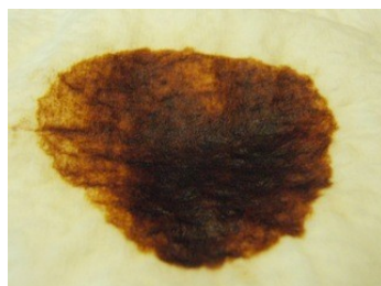
Figura 6. Óxido férrico hidratado depositado sobre una servilleta de papel.
