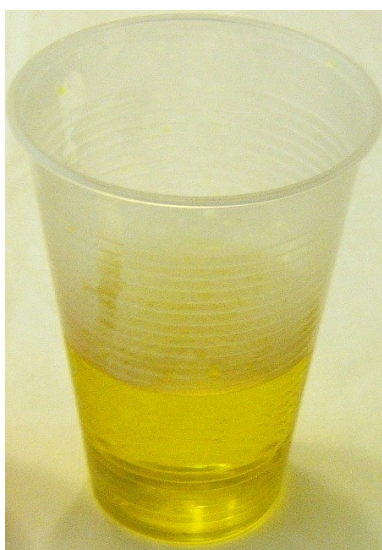
Figura 5. Disolución obtenida cuando se sumerge un clavo de hierro en ácido clorhídrico (plato 3).
