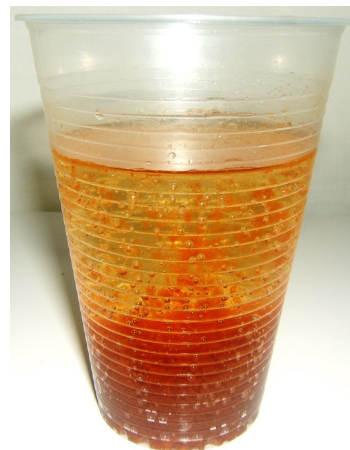
Figura 2. Disolución obtenida cuando se sumerge un clavo de hierro en agua del grifo (plato 1).
