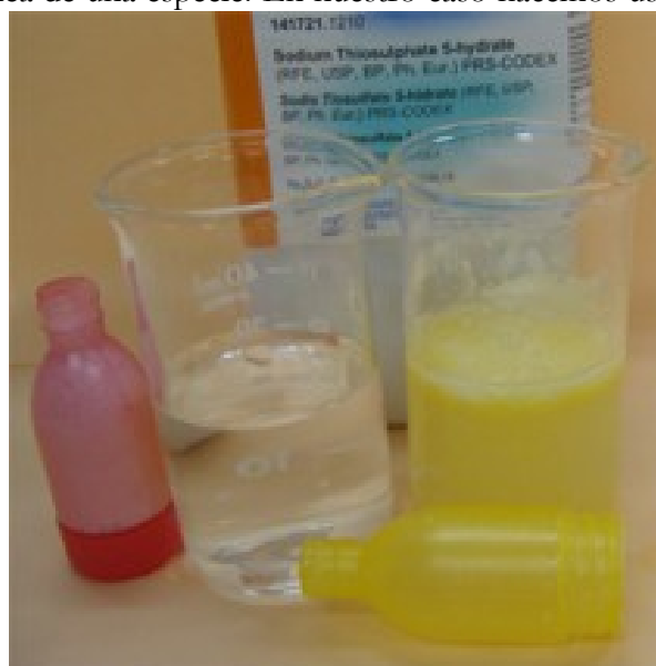
Figura 8. Botellitas de polvos. El vaso de la izquierda contiene la disolución saturada de tiosulfato de sodio. En el vaso de la derecha se ha mezclado el contenido de las botellitas con la disolución de tiosulfato de sodio; se pueden observar las burbujas de \text{SO}_2 .
