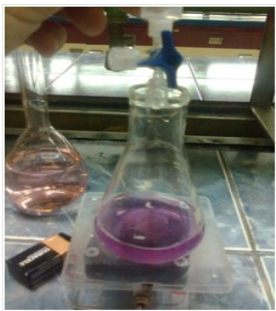
Figura 4. Determinación de la acidez total de un vino: a) Viraje del indicador “fenolftaleína” preparado a partir de laxantes. La titulación del vino tinto se realizó utilizando el equipo de valoración: bureta y agitador construidos con materiales de bajo costo.
