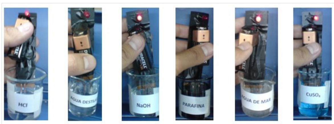
Figura 2. Medición de la conductividad eléctrica en soluciones acuosas. El encendido del diodo LED indica conductividad en la solución.
