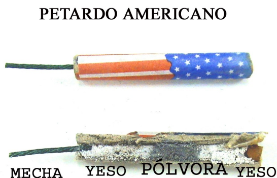
Figura 2. Interior de un petardo americano y combustión del petardo sin explosión.
