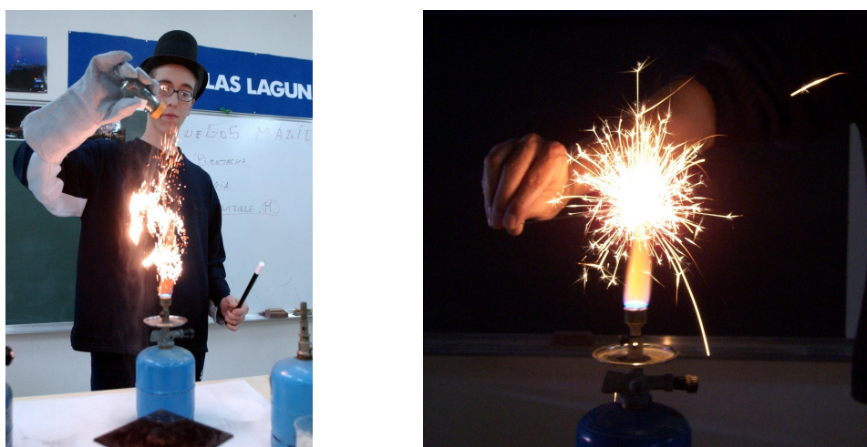
Figura 7. Chispas doradas de hierro pulverizado sobre mechero (izq.) y en bengala (der.).
