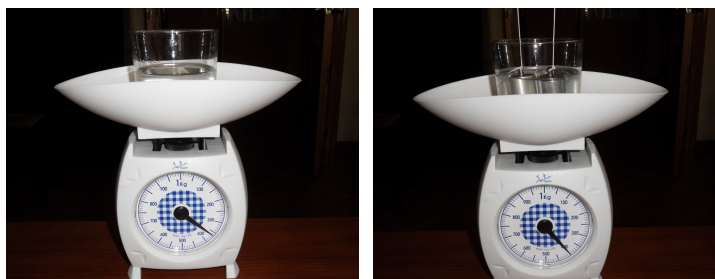
Figura 3. Constatación de la fuerza de empuje y su reacción. (Izq.) 365 g si sólo hay un vaso con agua. (Der.) Si se cuelgan y sumergen dos cilindros de 18 \text{ cm}^3 sube a unos 400 g, aunque se están sujetando los hilos.
