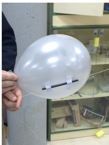
Figura 6. Globo a punto de soltarse para moverse a reacción.
