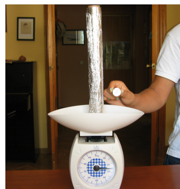
Figura 8. La balanza indica que la masa del aluminio es 265 g. Cuando el imán va cayendo marca 295 g.
