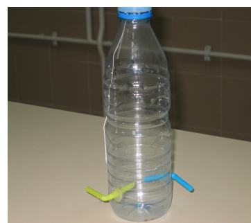
Figura 4. Al llenarse de agua y tirar del hilo, la botella gira en sentido contrario al de la salida del agua.
