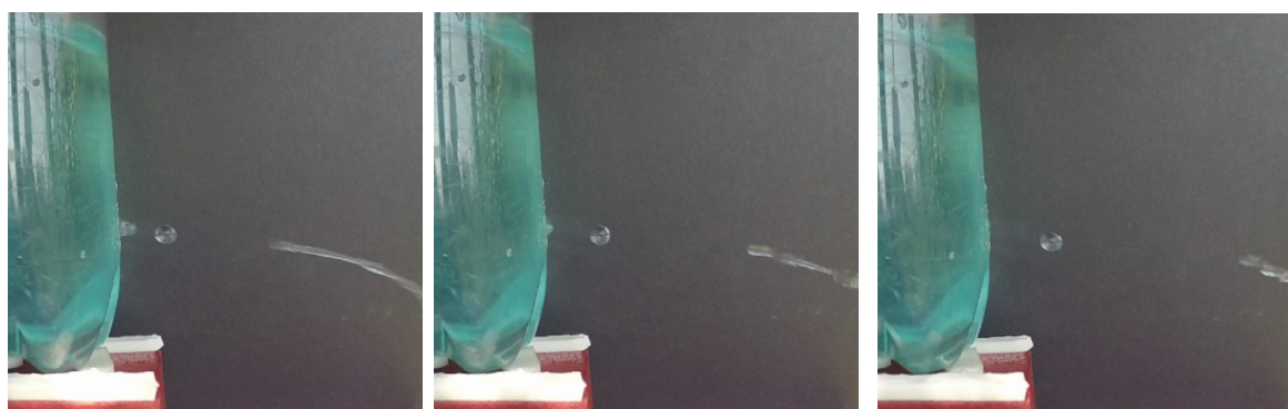
Figura 5. Tres partes del chorro están completamente separadas. La primera y la segunda imagen corresponden a los instantes 5/60 y 6/60 segundos después del comienzo de la caída libre.
