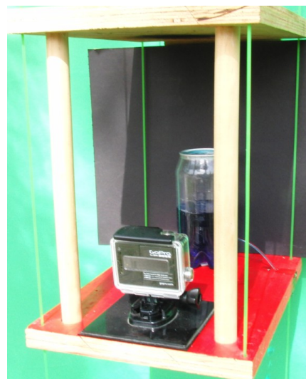
Figura 2. La plataforma con la cámara y el recipiente con el agua azul de la que sale un chorro.
