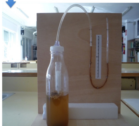
Figura 4. Imagen del diseño experimental, antes y después de la incubación a 37 °C, durante 48 horas, para comprobar la reducción de la presión de gases en el interior de un sistema cerrado, basado en el desplazamiento del líquido coloreado del interior del manómetro.
