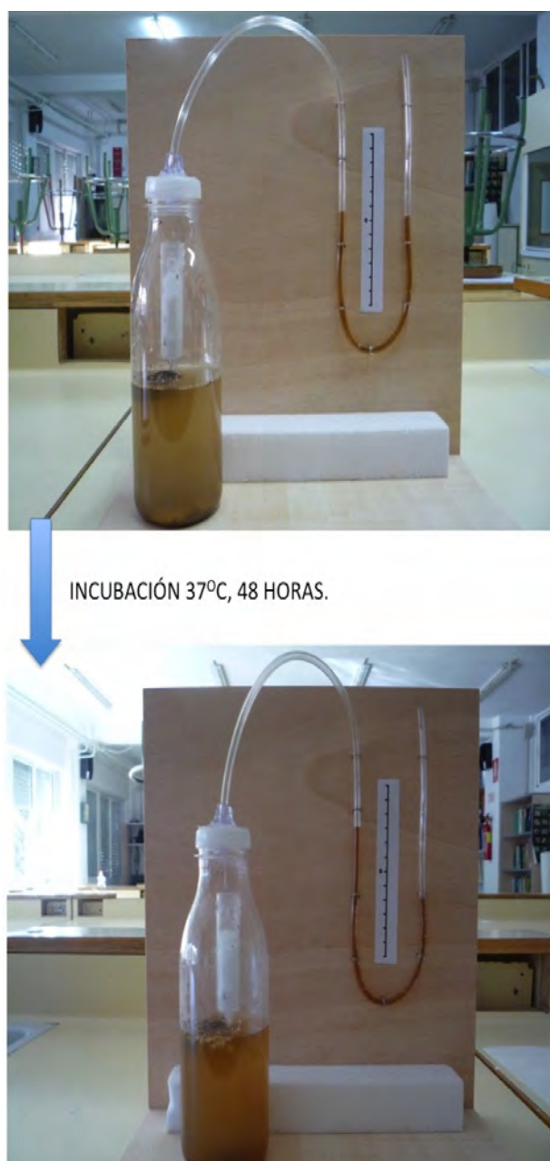
Figura 5. Imagen del diseño experimental, antes y después de la incubación a 37°C, durante 48 horas, para comprobar la reducción de la presión de gases en el interior de un sistema cerrado, basado en el desplazamiento del líquido coloreado del interior del manómetro.
