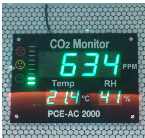
Figura 1. Concentración, expresada en ppm, de dióxido de carbono detectado con un medidor fijo en un aparcamiento subterráneo de automóviles en el centro de una ciudad española. Imagen tomada en diciembre de 2016. Denótese como el valor supera en 225 puntos la concentración media de este gas en la atmósfera.
