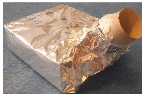
Figura 2. Aspecto del espectroscopio casero.
