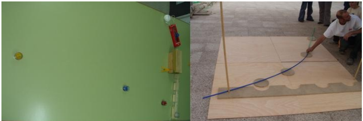
Figura 2.- Después de chocar la regleta con el obstáculo salen las tres velas con sus correspondientes velocidades v_i , recorriendo distintas distancias s_i . La figura de la derecha representa el resultado de la experiencia realizada a gran escala en la Feria Madrid es Ciencia de 2003 (Sierra et al. , 2003).
