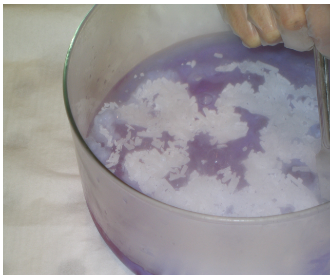
Figura 1.- Cristalizador en el que se observa la placa de hielo en formación y el desprendimiento de \text{CO}_2 (sublimación del hielo carbónico).
