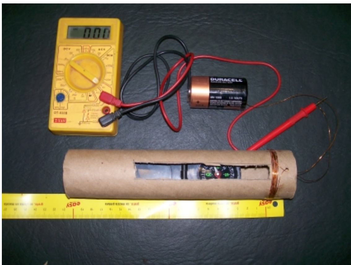
Figura 1.- Se observa el magnetómetro, las conexiones y el multímetro para medir la corriente.
