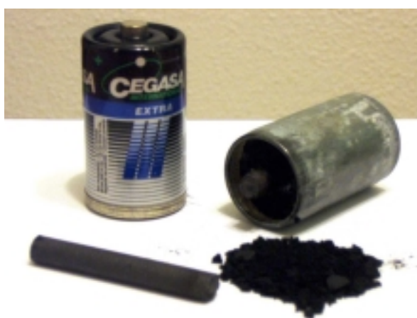
Figura 13.- Partes que componen una pila salina: el recipiente de cinc, el electrodo de carbono y el polvo de dióxido de manganeso.
