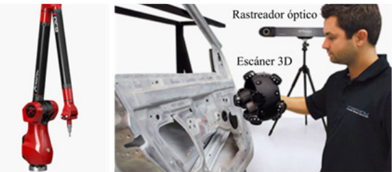
Figura 11. Brazo de medición (izquierda) y sistema óptico de posicionamiento (derecha).
