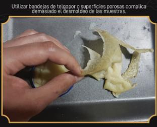
Utilizar bandejas de telopor o superficies porosas complica demasiado el desmoldeo de las muestras.
