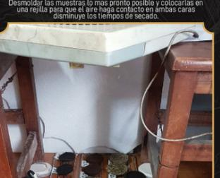
Desmoldar las muestras lo mas pronto posible y colocarlas en una rejilla para que el aire haga contacto en ambas caras disminuye los tiempos de secado.
