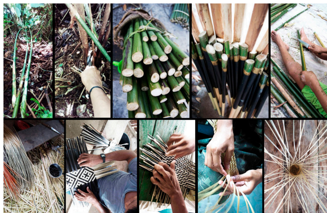
Figura 2. Processo di estrazione della fibra di Arumã e lavorazione artigianale (Ricardo, 2014; Mouco, 2022).
