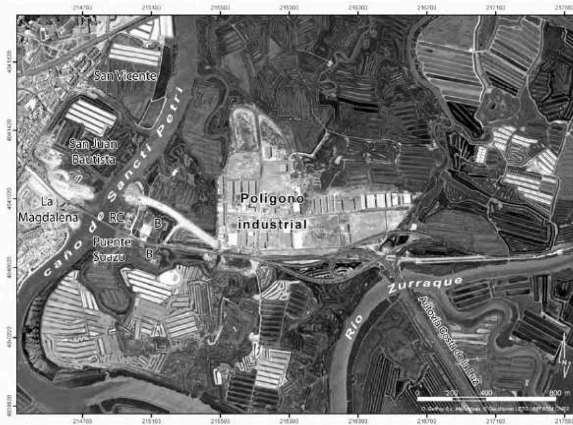
Figura 10. Relleno de salinas en Tres Caminos (T.M. Puerto Real) para crear un polígono industrial (54 ha). Las infraestructuras de carreteras (rotondas, enlaces) han afectado el paisaje salinero en Tres Caminos. El acceso al nuevo puente sobre el caño de Sancti Petri está en fase de construcción. Se aprecia el contraste entre las salinas en actividad (como las del Águila, al este del polígono industrial, de San Juan Bautista y San Vicente), las abandonadas (como al norte y oeste del mismo polígono) y las reconvertidas para uso acuícola (como, a la derecha, al norte y al sur). Al sur del puente Suazo, la salina San Felipe es de uso mixto (salinero y piscícola); la de la Magdalena está rellenada para uso urbano. Indicaciones: RC, Real Carenero; B, baluartes (San Pedro y San Pablo que defendían la cabecera oriental del puente Suazo). Detalle de una fotografía aérea vertical del vuelo de 1999 (Junta de Andalucía). Proyección: UTM 30 WGS 84.
